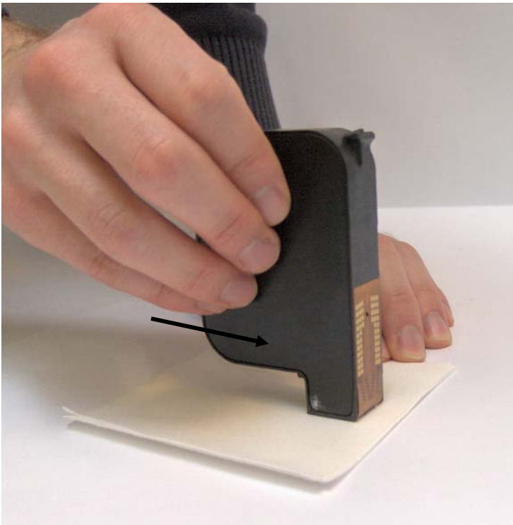
Abbildung 49: Reinigen der Düsenplatte
